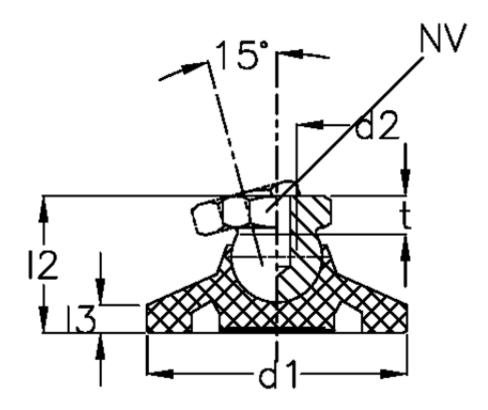
d1 = 25 d2 = M 6 l2 = 18.5 l3 = 4.0 NV = 12.0 Static load (N) = 5000 t min = 9.0
